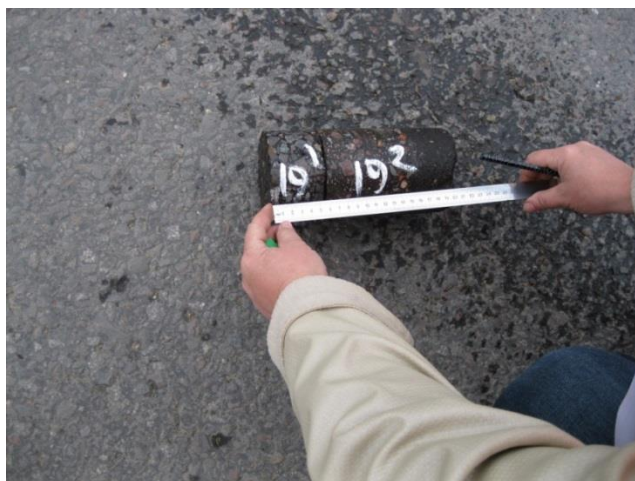
Рисунок 5 – Фотофиксация толщины асфальтобетонных слоев дорожной одежды
